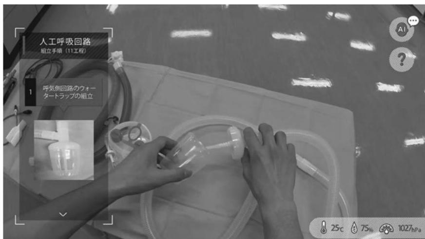
図3 適正な手順（左側）を表示と音声でナビゲーションさせる
